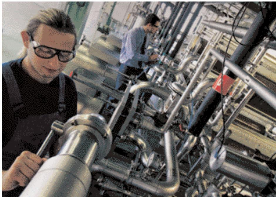
*Il sistema di filtrazione a membrana Plate & Frame System di Alfa Laval permette di scambiare le membrane in modo flessibile e veloce*
