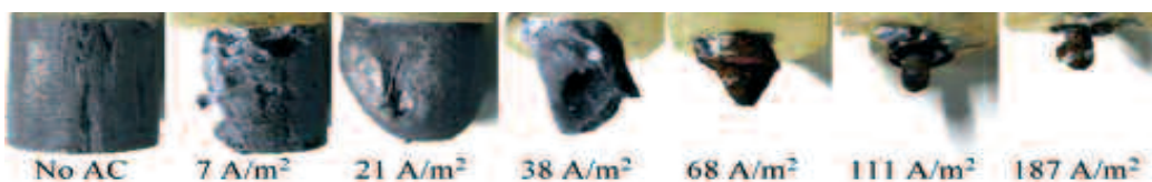
Fig. 4 - Provine di Mg, immerse in sabbia umida per 36 giorni, con diversi livelli di interferenza da CA
