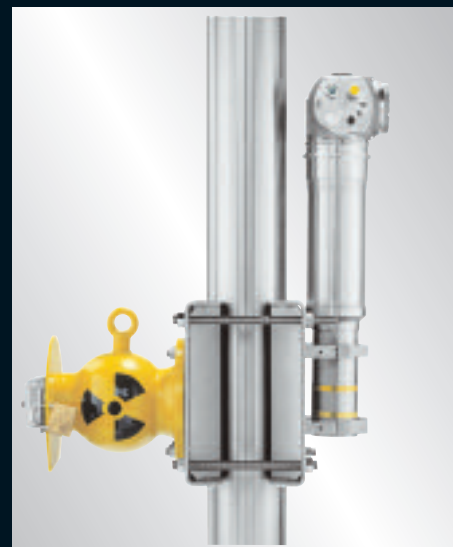
Gammapiot. La misura radiometrica è usata per il rilevamento di soglia, livello, strato di interfaccia e densità.
