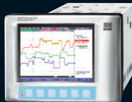
Registratore videografico che visualizza graficamente da 8 a 16 ingressi analogici o sino a 37 ingressi digitali, utilizzando il più moderno protocollo Profibus DP o ingressi universali.
