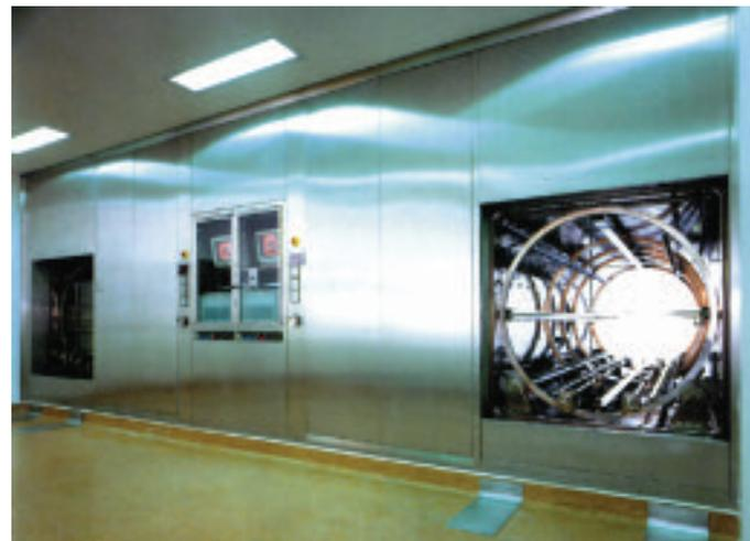
Autoclave da sterilizzazione con carico rotante
