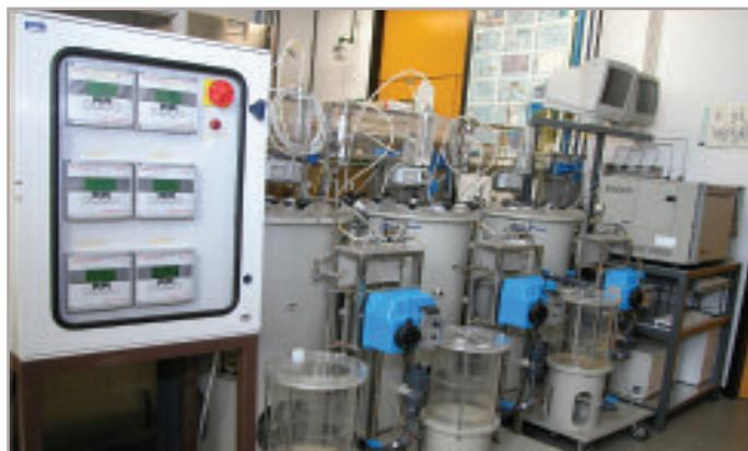
Fig. 3 - Appareti di simulazione per la biodegradazione di contaminanti organici presenti in un suolo saturo
