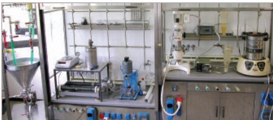
Fig. 2 - Apparati sperimentali di laboratorio per l'esecuzione di test di soil washing/estrazione con solvente. Da destra a sinistra: vibrovaglio a umido, cella di attrizione, cella di flottazione, girafusti e (appoggiato in verticale) reattore cilindrico utilizzato per l'estrazione con solvente, rack per l'esecuzione di separazioni liquido/solido mediante due idrocycloni
