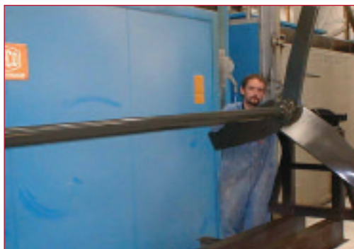
Miscelatore assiale di 3.300 mm di lunghezza con dispositivo a pala di 1.000 mm di diametro, rivestito in MC3005
