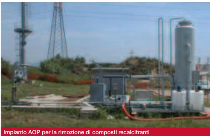
Impianto AOP per la rimozione di composti recalcitranti
