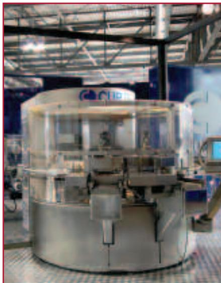
caricamento prodotto in funzione del formato richiesto. Un sistema di monitoraggio video verifica ogni posizione di carico. Nelle stazioni successive avviene la formatura e chiusura della parte inferiore
