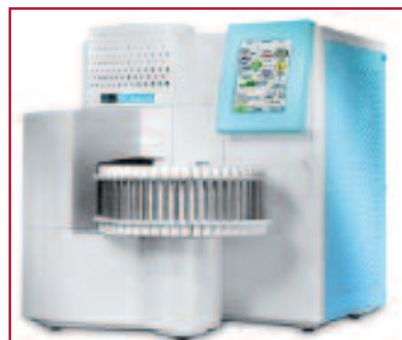
Fig. 1 – Il TurboMatrix 650 ATD. Si nota lo schermo tattile (per l'impostazione e il controllo delle variabili operative) e il caricatore con inseriti verticalmente i tubi di adsorbimento in acciaio
