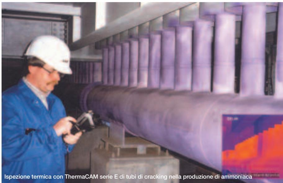
Ispezione termica con ThermoCAM serie E di tubi di cracking nella produzione di ammoniaca
