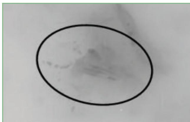
Fig. 9 - Immagini ottenute con TEM di una nanocarica organicamente modificata in gomma isoprene. Indagine realizzata da Giovanna Costa, Lucia Colzatti ISMAC-CNR, Genova
