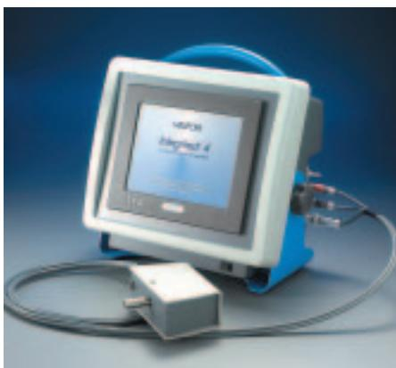
Integritest 4, recentemente introdotto sul mercato da **Millipore** per test d'integrità veloci e affidabili, soddisfa i requisiti normativi per tale tipo di prove. Lo strumento consente a operatori, ispettori e responsabili della validazione del processo farmaceutico di controllare in situ e con il più alto livello di sicurezza dischi, cartucce e filtri per la filtrazione a flusso tangenziale, utilizzando il metodo del
