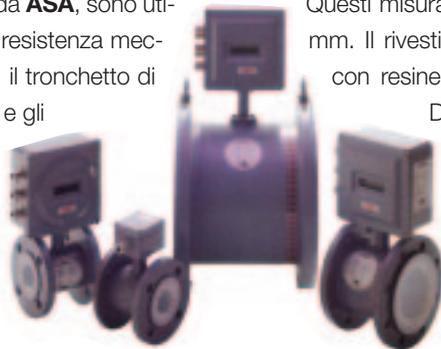
Questi misuratori di portata sono fornibili con DN da 4 a 1.000 mm. Il rivestimento esterno è in acciaio al carbonio verniciato con resine epossidiche, mentre quello interno è in PTFE o Diflex sino al DN 125; nei diametri superiori, il rivestimento standard è in ebanite alimentare e, a richiesta, in PTFE. Gli elettrodi sono di serie in Aisi 316L, ma possono anche essere forniti in Monel, Hastelloy B o C, titanio ecc. La precisione è garantita da impianti di calibrazione di diversa impostazione.
