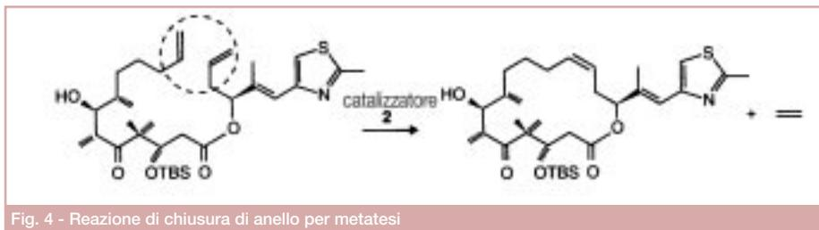
Fig. 4 - Reazione di chiusura di anello per metatesi
