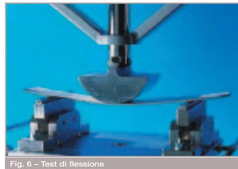
Fig. 6 – Test di flessione
