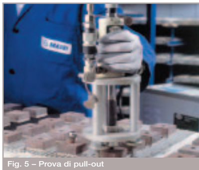
Fig. 5 – Prova di pull-out
