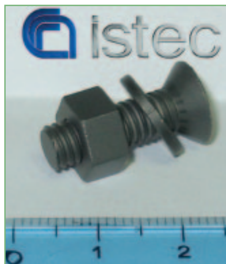
Fig. 1 - Esempio di manufatto di forma particolarmente complessa (vite+dado+rondella) prodotto in composito ZrB_2 -SiC-MoSi 2 mediante pressatura a caldo e successiva elettroerosione (la lavorazione mediante elettroerosione è stata eseguita presso l'azienda Andalò - Imola)
