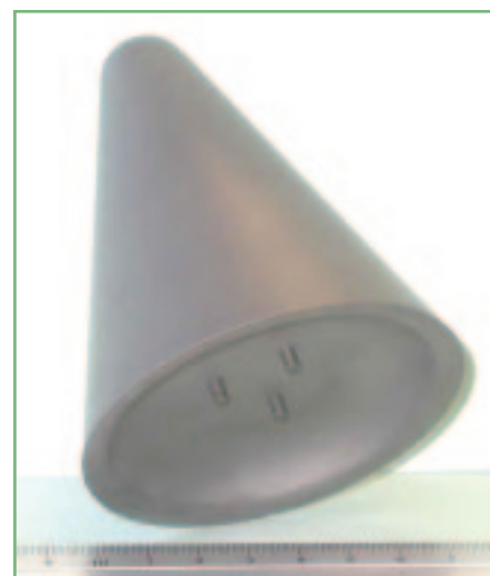
Fig. 2 - Cono di prua di un veicolo spaziale, realizzato presso ISTEC mediante pressatura a caldo e successiva finitura in composito ZrB_2 -SiC, su commessa del CIRA (Centro Italiano Ricerche Aerospaziali) (la lavorazione mediante elettroerosione è stata eseguita presso l'azienda Andalò - Imola)
