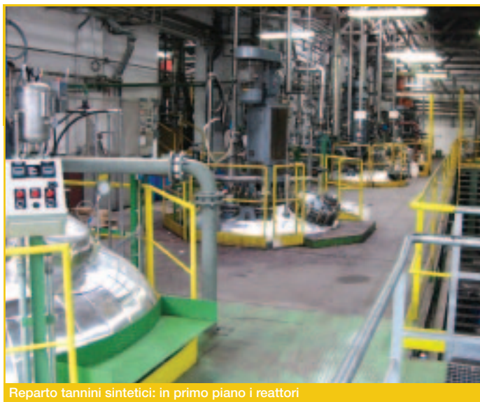
Reparto tannini sintetici: in primo piano i reattori
