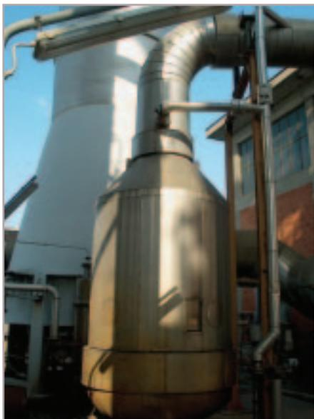
Fig. 4 - Impianto Radici Chimica - Novara. Reattore catalitico SCR in un impianto acido nitrico a bassa pressione
