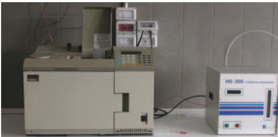
Programma di temperatura GC1: da 50 °C a 280 °C a 10 °C/min. Programma di temperatura GC2: da 45 °C (2,5 min.) a 180 °C (8 min.) a 10 °C/min. FID1 (280 °C):  $H_2$ : 20,0 mL/min.; Aria: 400,0 mL/min.; make up (He): 40,0 mL/min. Velocità di campionamento: 20 msec. FID2 (210 °C):  $H_2$ : 50,0 mL/min.; Aria: 400,0 mL/min.; make up (He): 30,0 mL/min. Velocità di campionamento: 20 msec.
