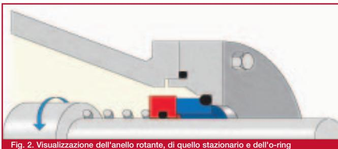
Fig. 2. Visualizzazione dell'anello rotante, di quello stazionario e dell'o-ring
