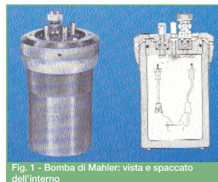
derato che il c.d. "rifiuto" da analizzare conteneva solventi infiammabili, che nelle condizioni della "mineralizzazione" del cloro organico in atmosfera di O<sub>2</sub> sotto alta pressione (25-40 bar) avrebbero formato un'atmosfera esplosibile. Inoltre, disattendendo le prescrizioni di sicurezza ASTM, oltre al più comune buon senso, hanno ripetutamente "sbattuto" sul banco la bomba caricata e pronta per l'innesco.
