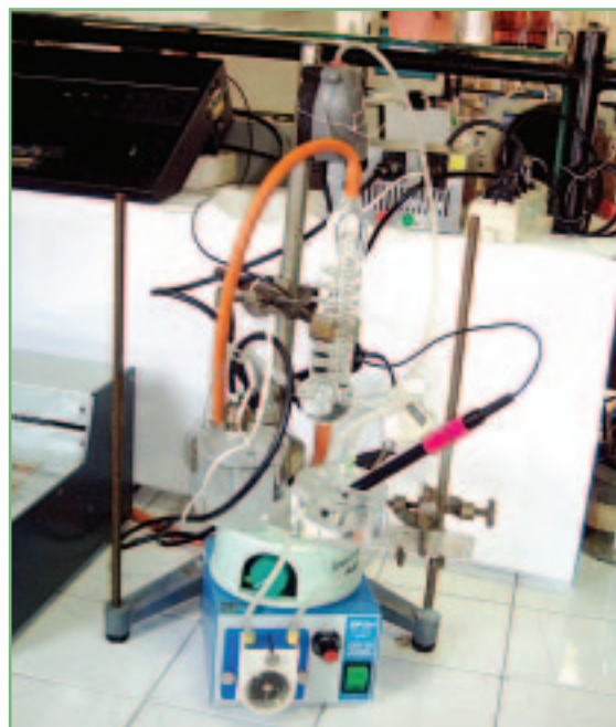
Fig. 3 - Foto del nuovo sistema per la determinazione del TOC: sulla sinistra la cella di degradazione in PMMA, sulla destra la cella di misura. Fra le due celle è visibile il refrigerante, sotto le celle si nota l'agitatore e la pompa peristaltica. Sul ripiano il pH metro di misura e l'alimentatore
