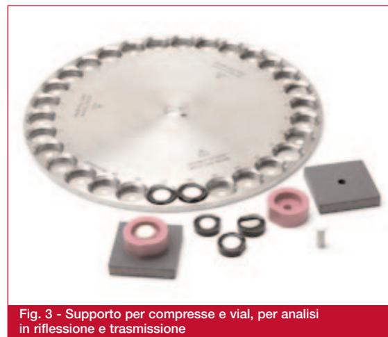
sa la compressa e la componente di trasmissione diffusa viene acquisita e letta dal secondo detector InGaAS, posto sopra il piatto dell'autocampionatore e operante nell'intervallo da 12.000 a 6.000  $\text{cm}^{-1}$ . I dati acquisiti dal sistema NIR vengono elaborati con il software Spectrum Quant+, che consente di estrapolare dall'intero spettro le informazioni utili per determinare quantitativamente il componente o i componenti di interesse.
