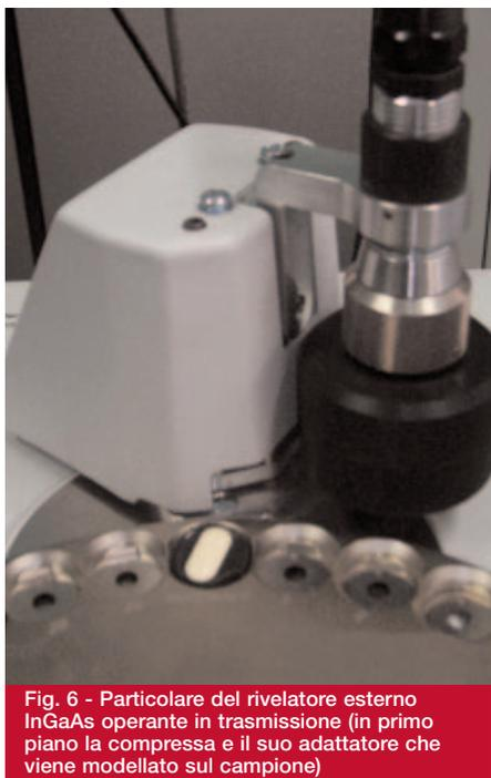
Fig. 6 - Particolare del rivelatore esterno InGaAs operante in trasmissione (in primo piano la compressa e il suo adattatore che viene modellato sul campione)
