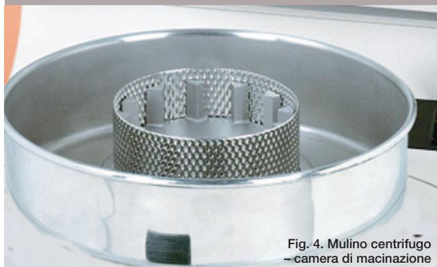
Fig. 4. Mulino centrifugo - camera di macinazione
