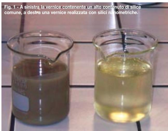
Fig. 1 - A sinistra la vernice contenente un alto contenuto di silice comune, a destra una vernice realizzata con silici nanometriche.
