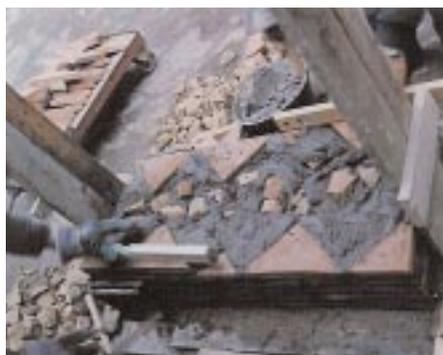
Fig. 1 - Muratura romana ricostruita presso la Facoltà di Ingegneria dell'Università "La Sapienza" per effettuare studi sulle resistenze meccaniche delle murature antiche. Di norma gli spessori delle murature originarie sono più grandi
