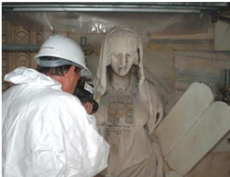
Fig. 6 - Termocamera in funzione sulle stuccature della Statua della Giustizia della Facciata del Duomo di Milano
