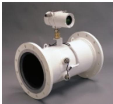
Faure Herman FH 8300 di **Socrate** è dedicato alla misura di liquidi, conduttori o meno, anche aggressivi. Il principio di funzionamento di questo misuratore di portata a ultrasuoni si basa sul rilevamento del tempo di transito.
