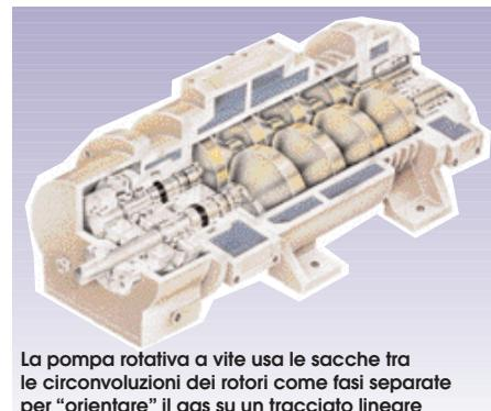
La pompa rotativa a vite usa le sacche tra le circonvoluzioni dei rotori come fasi separate per "orientare" il gas su un tracciato lineare
