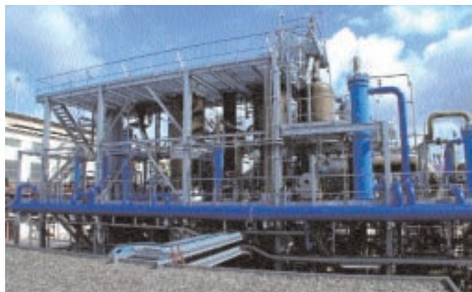
dabilità elevata ed è in grado di funzionare fino a 8500 h/a; inizialmente è stato utilizzato per la distribuzione di residui clorati e/o fluorati a concentrazione di alogenati variabile da debole a molto forte, con riottenimento contemporaneo di energia mediante la produzione di vapore.
