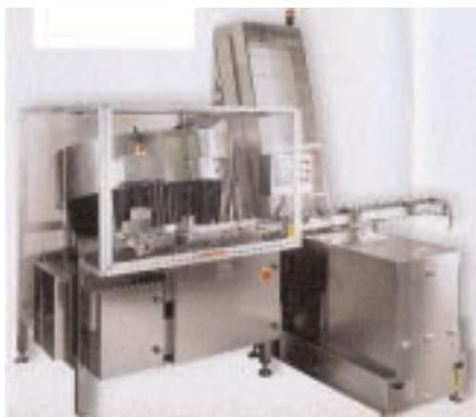
La gamma di riordinatrici O.Z.A.F. permette di lavorare con i più svariati tipi di flaconi; la flessibilità di questo tipo di impianto e il rapido cambio formato consentono il riordino di uno o più formati di flaconi impiegando la stessa macchina. La riordinatrice
