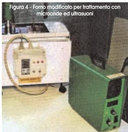
Figura 4 - Forno modificato per trattamento con microonde ed ultrasuoni
