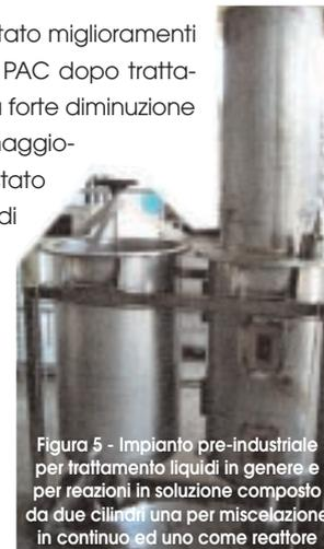
Figura 5 - Impianto pre-industriale per trattamento liquidi in genere e per reazioni in soluzione composto da due cilindri una per miscelazione in continuo ed uno come reattore
