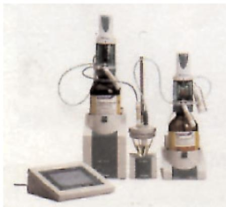
Dosino e unità di dosaggio vengono fissati direttamente alla bottiglia di reagente e, per evitare di dover aprire e chiudere l'unità di dosaggio, possono essere svuotati con il relativo comando.
