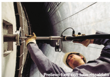
Prelievo fumi con tubo riscaldato
