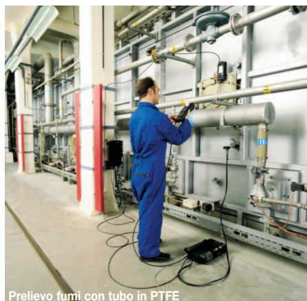
Prelievo fumi con tubo in PTFE
