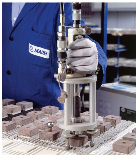
Figura 2 - Prova di pull-out
