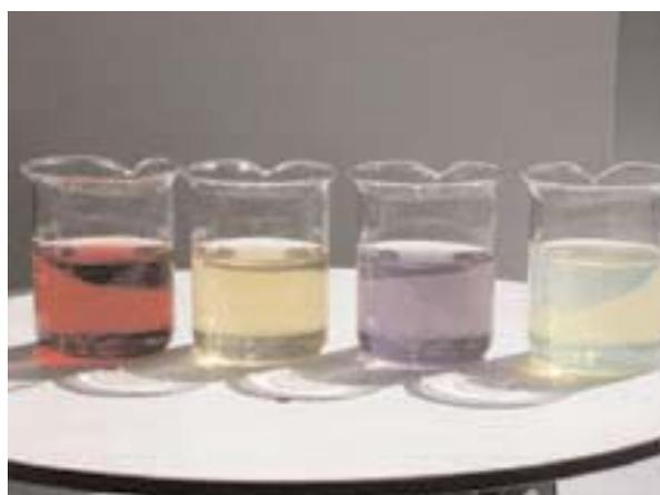
Figura 2 - Fotografia di sospensioni nanoparticellari. Da sinistra verso destra: Au<sup>0</sup>, CeO<sub>2</sub>, CoAl<sub>2</sub>O<sub>3</sub>, TiO<sub>2</sub> 2% w/w
