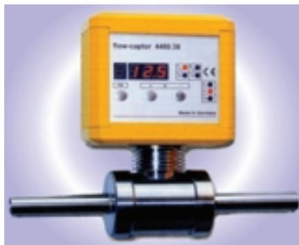
tubo in linea di diametro 4 o 6 mm che riescono ad apprezzare portate dell'ordine di pochi millilitri al minuto. Per liquidi particolarmente aggressivi sono fornibili teste di misura rivestite in hastelloy o titanio. Per fluidi contenenti materiale abrasivo la testa di misura in titanio-ceramica consente una misura affidabile e un'ottima resistenza nel tempo.
