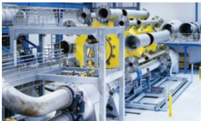
Sala di calibrazione di Cernay per strumenti di grandi dimensioni
