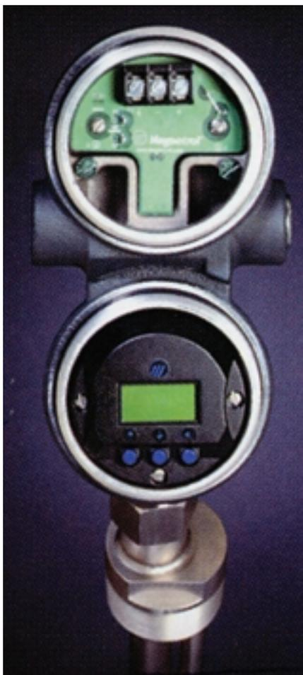
Vista dei due comparti "cablaggio" (superiore) ed "elettronica" (inferiore) di un trasmettitore di livello della serie Eclipse
