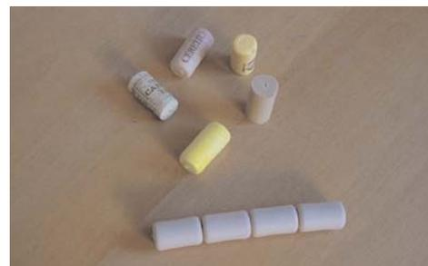
Figura 1 - Tappi sintetici di vario tipo, prodotti per stampaggio e per estrusione
