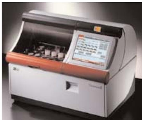
Il campo d'applicazione come analizzatore universale di elementi nel controllo di qualità e di processo è molto vasto: si utilizza per materie prime minerali, prodotti ceramici, refrattari, cementi, catalizzatori, polimeri, oli lubrificanti e elementi in tracce nei combustibili, e anche come analizzatore flessibile per campioni non di routine.
