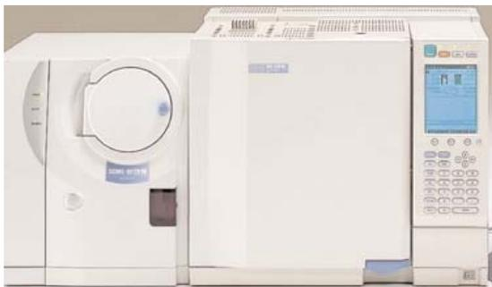
brevettato di lenti fuori asse, che offre all'utente una sensibilità elevata (1 pg Ofn: S/N>60). Grazie alla sorgente riscaldata separatamente e all'energia ionica variabile, è possibile impostare esattamente tutti i parametri analitici su misura per il campione da analizzare. L'ampio intervallo di misurazione (1,5÷1.024
