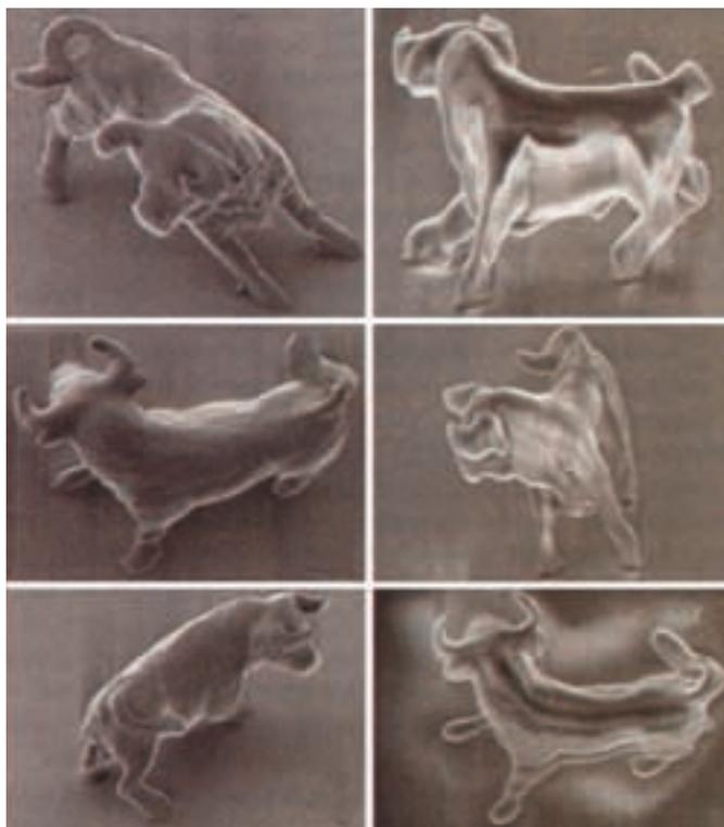
Micrografie a scansione elettronica della figura di un toro scolpito su una resina mediante un processo di fotopolimerizzazione a due fotoni. Queste sculture, esempio dell'alta definizione che può essere ottenuta con l'approccio "dall'alto" alla miniaturizzazione, sono lunghe  $10\ \mu\text{m}$  e alte  $7\ \mu\text{m}$  ed hanno all'incirca le dimensioni di un globulo rosso. Riprodotto su autorizzazione dal riferimento bibliografico [12]
