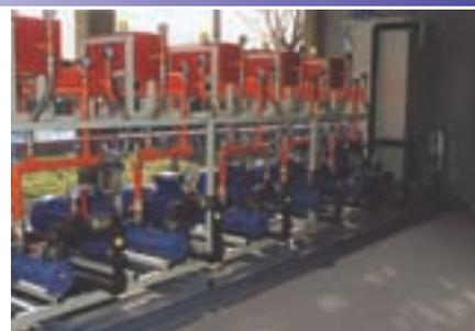
Macchina per microemulsione "turbotrasduttore"
