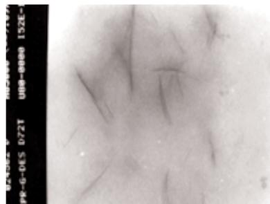
Figura 2 - Immagine Tem di un nanocomposito a base di EPM funzionalizzato e bentonite organofila [41]
