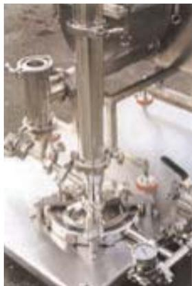
**Micronizzatore** utilizzato per l'ottenimento di granulometrie inferiori anche ai 5 micron
