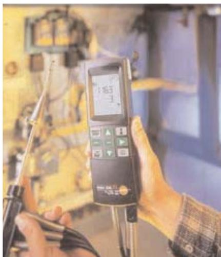
Uno strumento per analisi e controllo di gas combustibili
