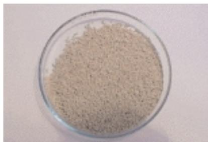
Figura 5 - Nelle formulazioni WG la sostanza attiva, i coadiuvanti e gli inerti sono tutti finemente macinati e poi sottoposti ad un processo di granulazione
