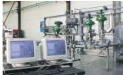
tre il software Ams ValveLink VL2000 LoopScanner, che viene usato per il training sul monitoraggio delle prestazioni e sulle procedure diagnostiche sulle valvole. Questo software permette ai tecnici Fisher di effettuare dimostrazioni sulle prove di funzionalità delle valvole e sui calcoli di variabilità del processo, si-
