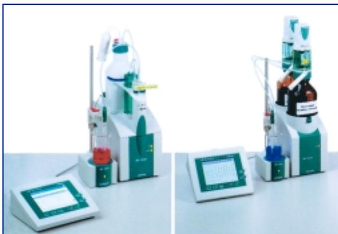
I Titrandò 808 e 809 hanno anche due interfacce Usb per il collegamento ad una stampante, una tastiera per Pc o un lettore di codici a barre.
