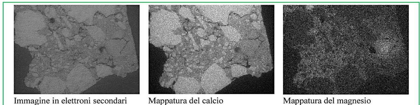
Figura 2 - Immagine Sem in elettroni secondari e mappature in fluorescenza di raggi X del campione PG22
