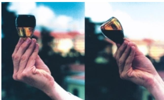
Figura 2 - Sostanza tissotropica solida (a sinistra) e liquida (a destra)
