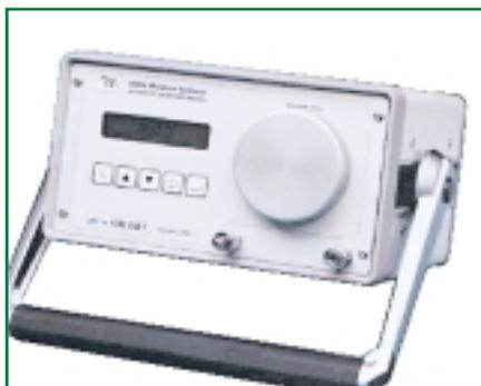
*Rilevatore-trasmittitore per il controllo del punto di rugiada per tutti i processi industriali, anche per zone pericolose*
