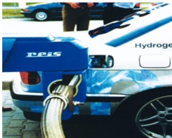
Figura 1 - Rifornimento di LH<sub>2</sub> ad un'automobile. La condotta di alimentazione, che è a chiusura ermetica verso l'esterno, è costituita dal tubo di adduzione dell'LH<sub>2</sub> e da quello di spurgo dell'LH<sub>2</sub> gassoso formato per evaporazione dell'LH<sub>2</sub>
