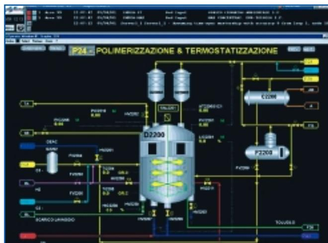
Figura 3 - Display grafico sezione di polimerizzazione
